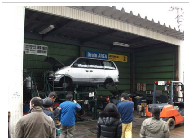
Figura 2 – Operação de drenagem de fluidos
